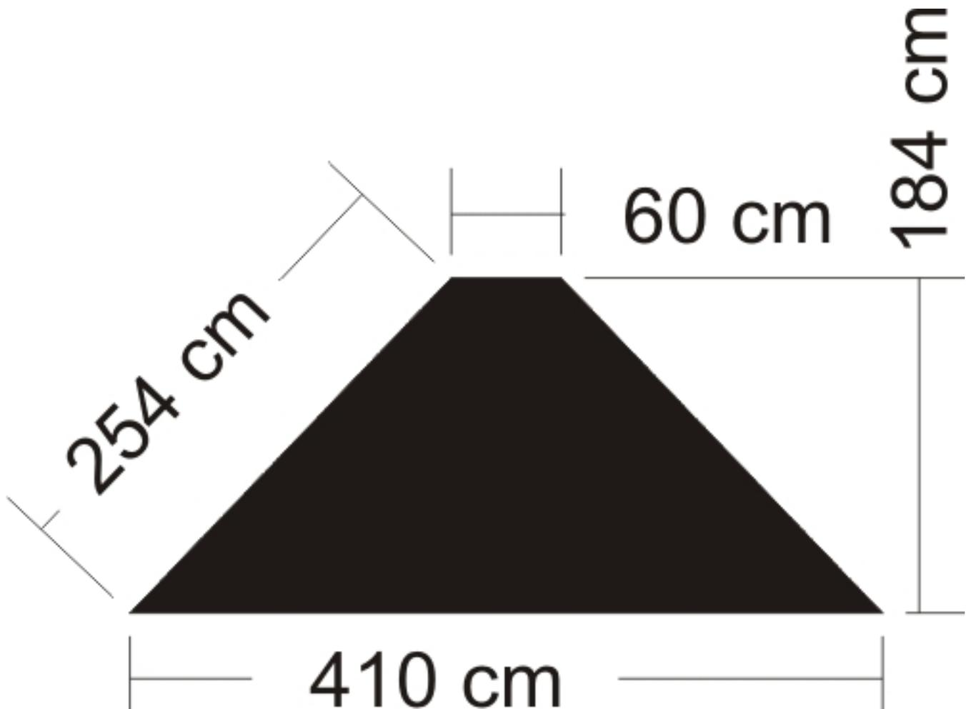
Kannst du in einer Kohte stehen? Wie hoch ist das Rauchloch über dem Boden? Das sind häufige Fragen, die an uns herangetragen werden. Die wichtigsten Maße wollen wir anhand der oberen Skizze kurz erläutern. Bei einem rechnerischen Seitenmaß von 157 cm entsteht ein Achteck mit einem Aussenradius von 410 cm. Das ist der Durchmesser am Boden der Kohte.
