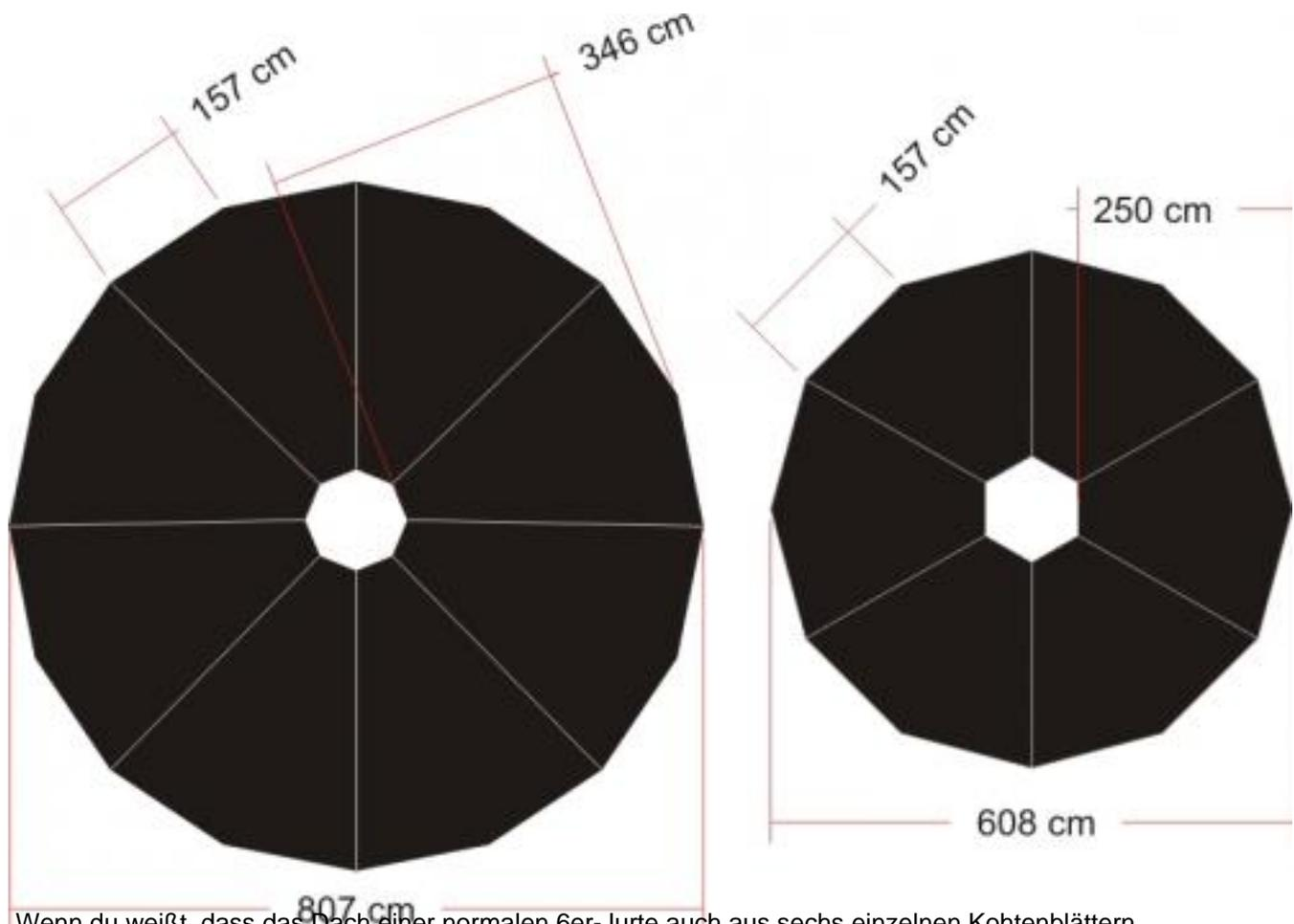
Wenn du weißt, dass das Dach einer normalen 6er-Jurte auch aus sechs einzelnen Kohtenblättern zusammengesetzt werden kann, dann liegt zugegeben, die Vermutung nahe, dass die 8er-Jurte (besser Großjurte) aus acht einzelnen Kohtenblätter zusammengesetzt werden könnte.
