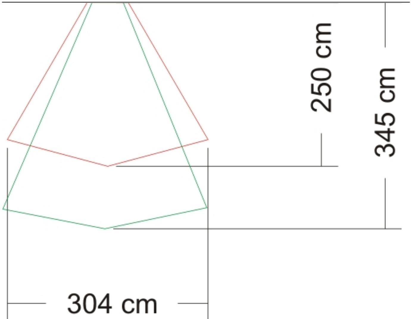
Auf diesem Bild siehst du die unterschiedliche Geometrie der beiden Dächer am besten. Die normale Jurte mit sechs Meter Durchmesser besteht in der Tat aus sechs Kothenblättern. Das ist der rote Umriss. Für die Großjurte mit acht Meter Durchmesser sind die beiden Grundseiten zwar gleich, aber die Höhe der Plane müßte deutlich größer sein.
